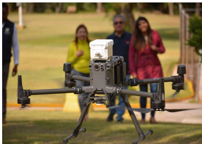
Imagen 3. Sniffer montado en drone Matrice 300.
