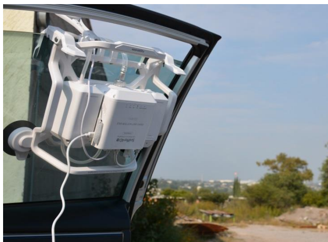
Imagen 2. Sniffer montado en vehículo.
